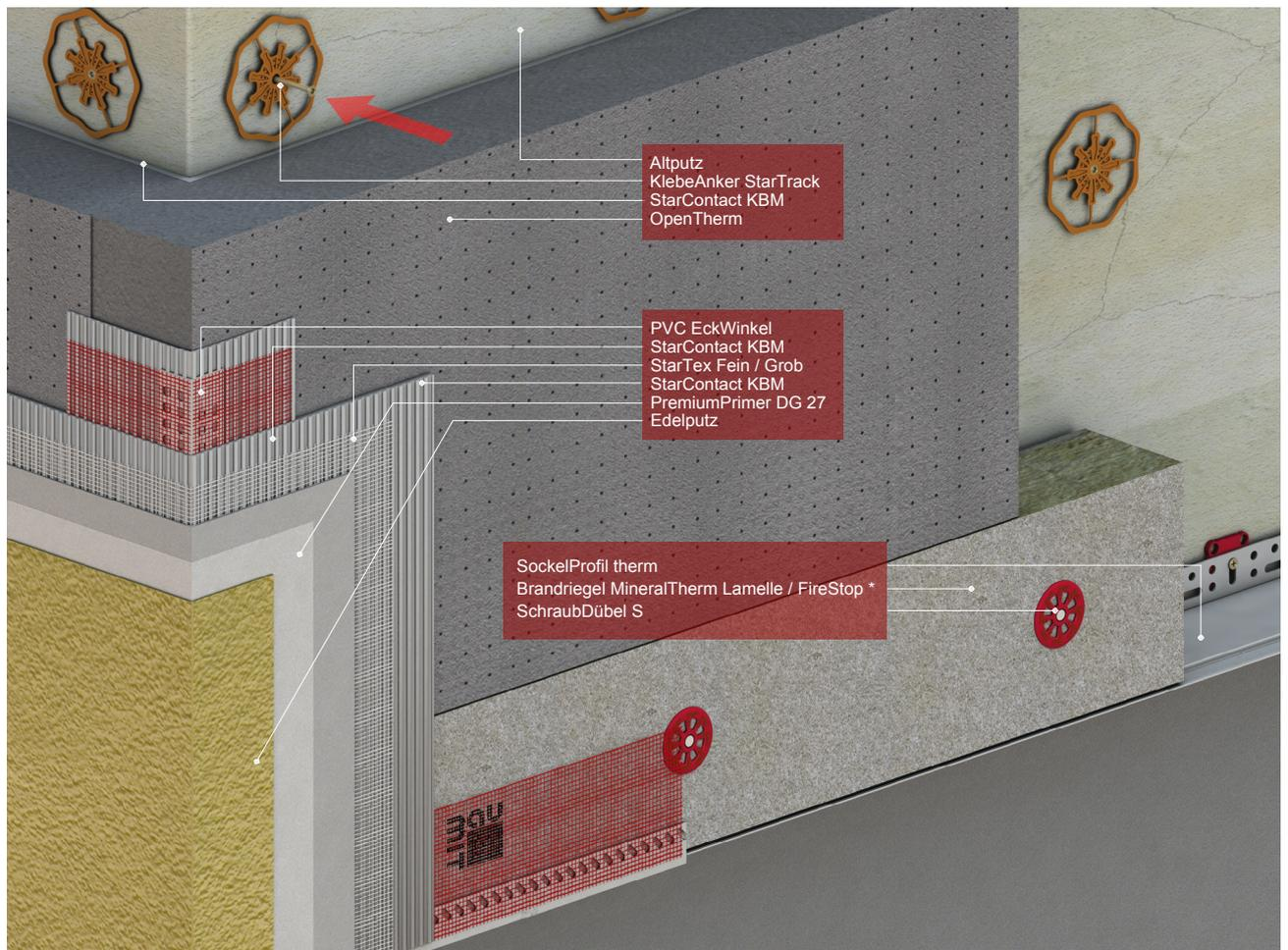
\* Zur Ausführung der konstruktiven Brandschutzmaßnahmen die allgemeine bauaufsichtliche Zulassung Z-33.49-1190 und die technische Systeminformation "WDVS und Brandschutz" des Fachverband WDVSsysteme beachten.
