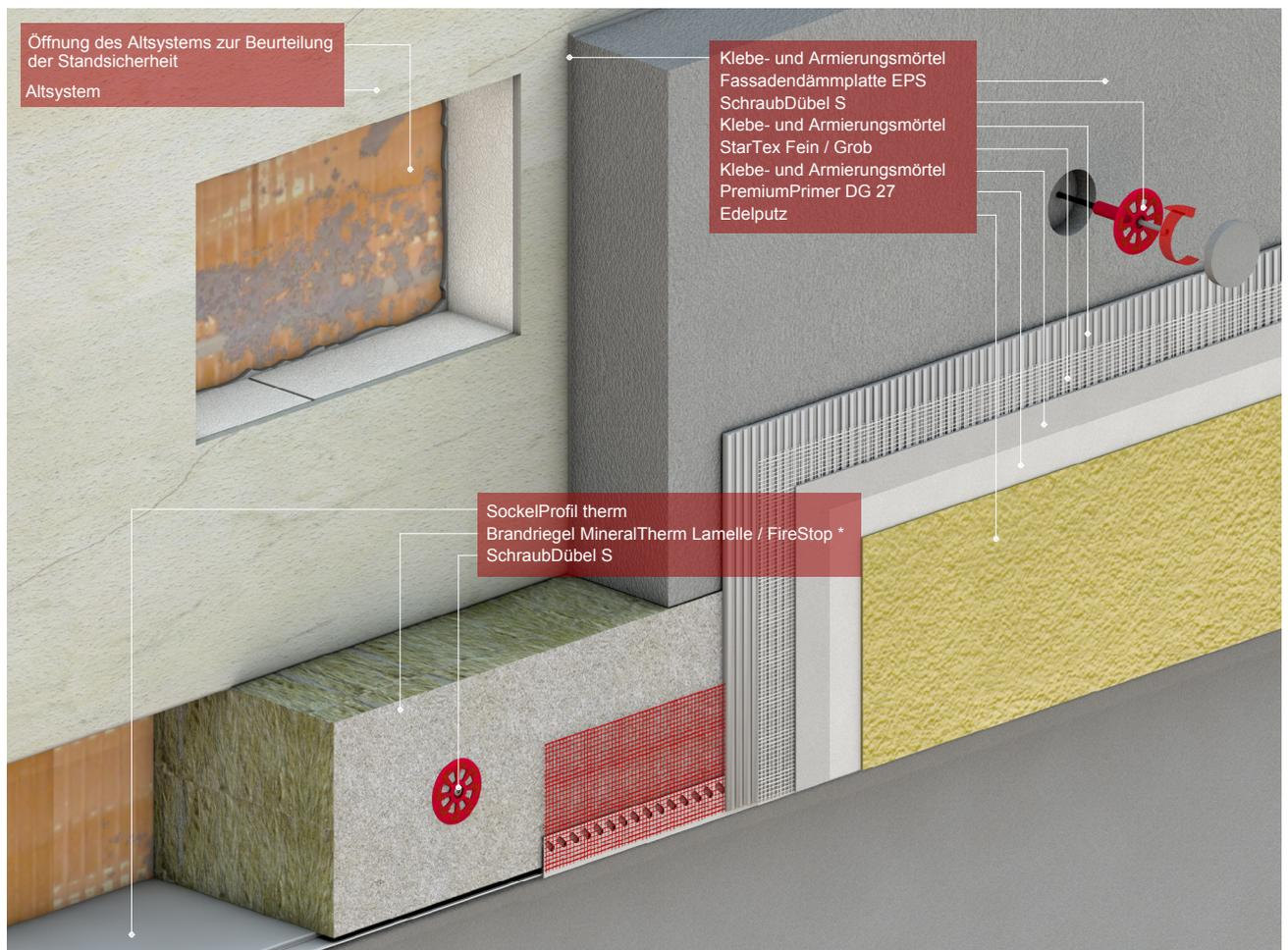
\* Zur Ausführung der konstruktiven Brandschutzmaßnahmen die allgemeine bauaufsichtliche Zulassung Z-33.4.3-51 und die technische Systeminformation "WDVS und Brandschutz" des Fachverband WDVSysteme beachten.
