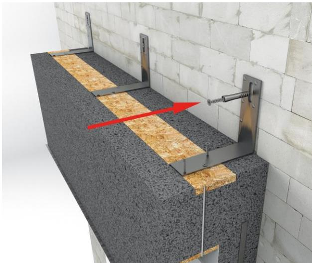
1. Die Winkel werden an der Wand und der oberen P7-Platte des Baunit Jalousiekastens verschraubt.
