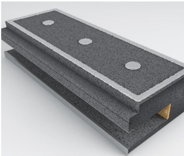
Die Verklebung des Kastens erfolgt i. d. R. im Punkt-Wulst-Verfahren an der Wand mit dem Klebe- und Armierungsmörtel des Wärmedämm-Verbundsystems. Anschließend den Kasten lot- und fluchtgerecht ausrichten.
