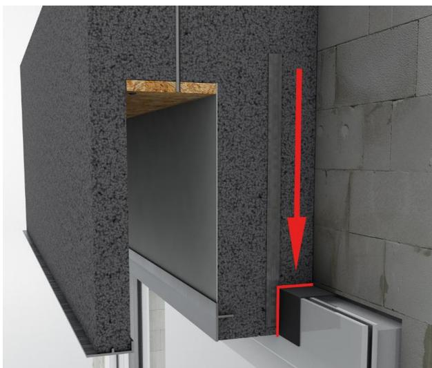
Um die Luftdichtheit zu gewährleisten, ist bei Überdämmung des Rahmens zwischen dem Fensterrahmen und dem Jalousiekasten ein geeignetes Fugendichtband, z. B. Baumit FugendichtBand FB, einzusetzen.
