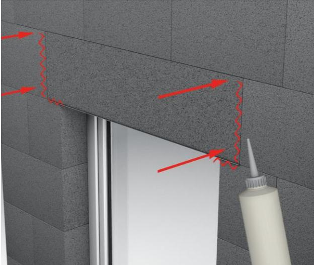
Die horizontalen Stöße der Auflager werden, genauso wie die Stöße von mehrteiligen Elementen, mit Baunit Füllschaum verklebt.
