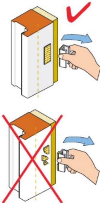
Ist dies der Fall, ist der Untergrund für eine Verklebung geeignet.
